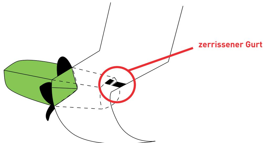
Unsere verschiedenen Tests zeigen, dass dieser Schaden an dem Container nicht auftritt, wenn der Rettungsschirm noch im Container steckt (geschlossen). Es besteht die Gefahr von Beschädigungen beim Aufprall, wenn das Gurtzeug ohne Rettungsschirm benutzt wird oder wenn der Rettungsschirm ausgelöst wurde.
